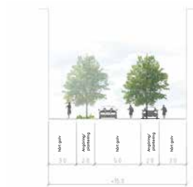
Principsektion lågfartsgata, 15 meter bred.
